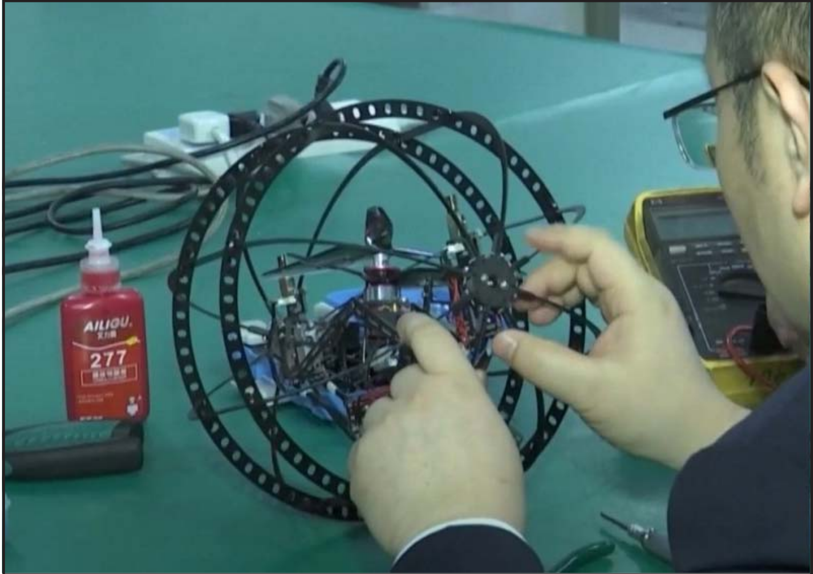
El prototipo de vehículo aéreo no tripulado (UAV) de doble propósito tierra-aire pesa solo 300 gramos
