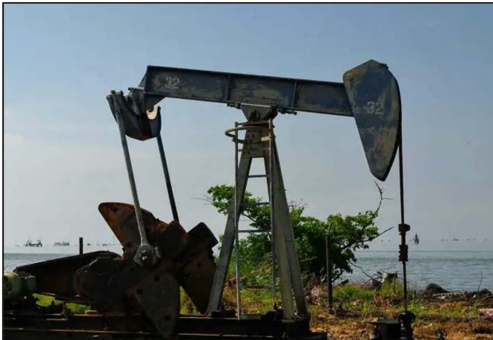
Una bomba extractora de petróleo de Petróleos de Venezuela en el Famoso Lago de Maracaibo en Cabimas, estado Zulia, Venezuela.
